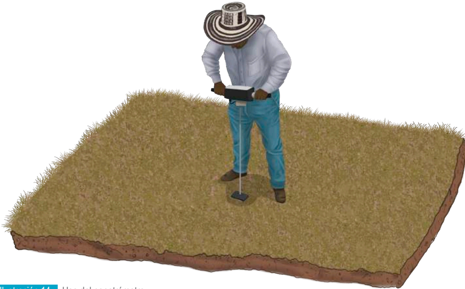
Ilustración 14. Uso del penetrómetro
